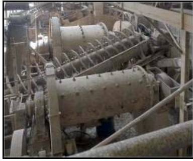
Fördertrommeln für Fluorsspatkonzentrat Santa Lucia, Sardinien Foto: Christian Brünig
